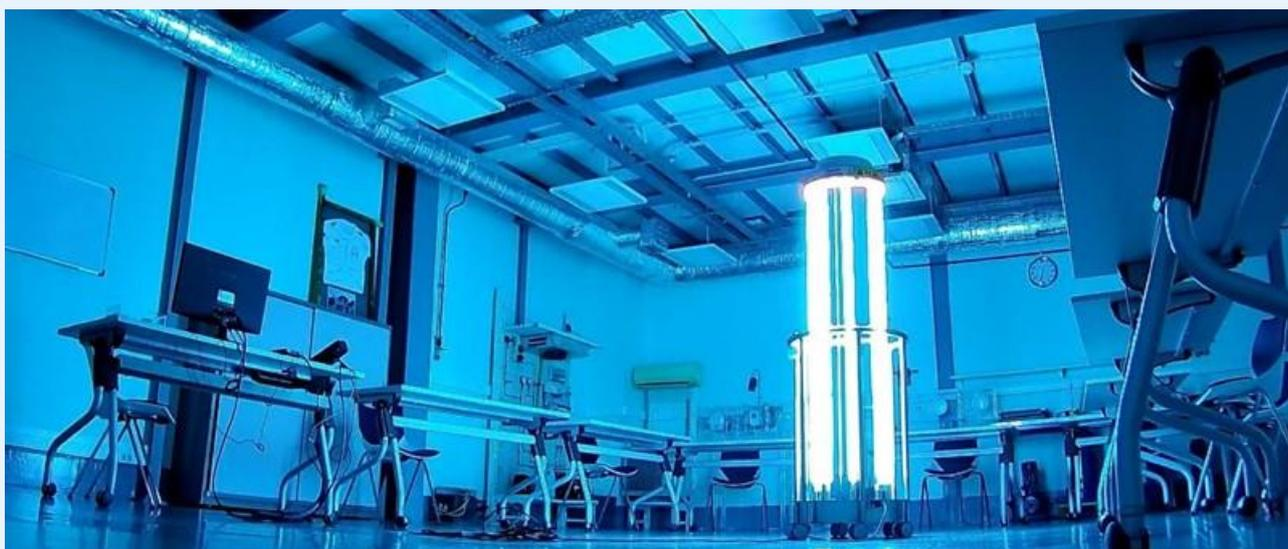
Robot de desinfeção por radiação UV-C
