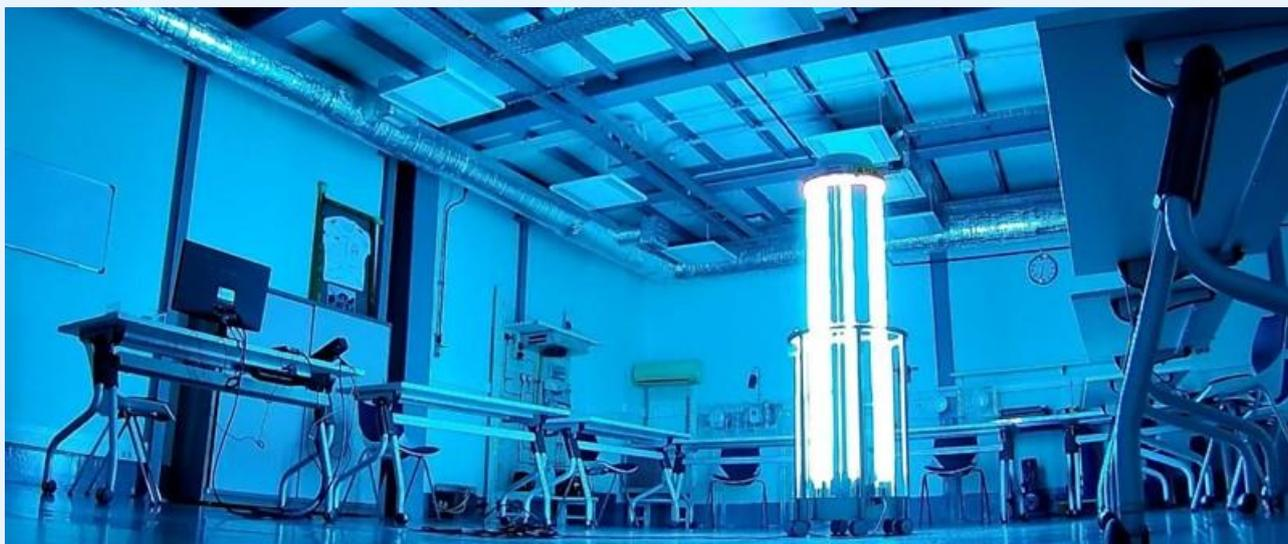
Robot de desinfeção por radiação UV-C
